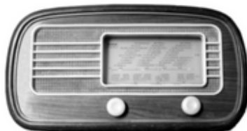
Onde medie e onde corte. Media frequenza 469 kc. Massima tensione anodica disponibile 165 V a 64 mA. Filamenti in serie a 110 volt.
